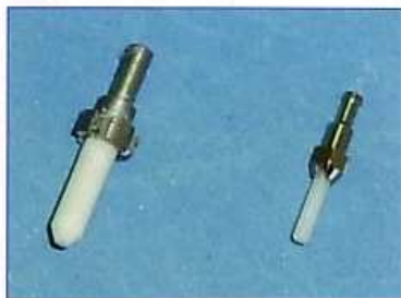
Rys. 1. Ferrule do złączy SC i MU o średnicach odpowiednio 2,5 mm oraz 1,25 mm
